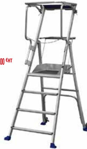
4 MARCHES - Aluminium - Dimensions plancher : 0,40 x 0,50 m - Charge utile : 150 kg - Larges marches antidérapantes de 80 mm - DÉCRET 2004-924 - NORME PIRL - Labellisé NF - Hauteur de travail : 2,95 m - Roues diam.100 mm non porteuses en position travail et non marquantes - DIMENSIONS PLIÉ : H 2,23 m x L 0,79 m x E 0,25 m - Passage libre de 0,54 m pour une meilleure performance sur les chantiers - Seule Plate-forme 4 marches sans stabilisateurs! - Fabriqué en France
