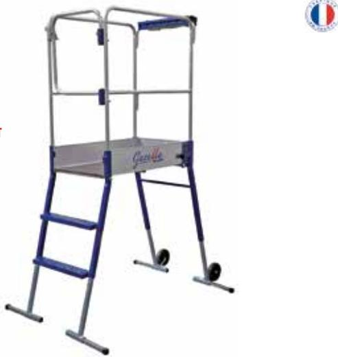
Acier/alu - Plus de confort de travail : avec un plancher spacieux 0,86 x 0,48 m - À l'aise en dénivelés : grâce à 4 pieds réglables indépendamment - 4 hauteurs de travail de 2,65 à 3 m - Dimensions pliées : L. 1,08 m x l. 0,68 m x Ep. 0,40 m - Charge utile : 150 kg - Garde-corps avec portillon sécurisé - Tablette multi-fonctions - marches XXL antidérapantes - Roues diam.150 mm non porteuses en position travail et non marquantes - DÉCRET 2004-924 - NORME PIRL - Labellisée NF - Fabriqué en France
