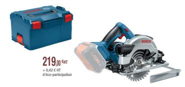
Régime à vide : 3 400 tr/min. Ø de la lame de scie : 165 mm. Ø alésage : 20 mm. Tension de la batterie : 18 V. Dimensions de l'emballage (longueur x largeur x hauteur) : 354 x 445 x 243 mm. Poids avec batterie : 4,1 kg. Livré en coffret L-Boxx.
