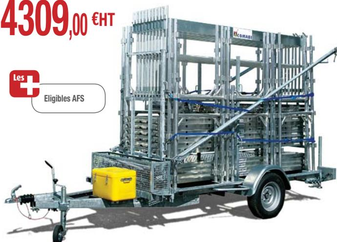
Remorque simple essieu avec container intégré pour le transport et le stockage de 88m<sup>2</sup> de R200 Progress ou Record. Compacte, maniable et facile à charger.
