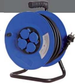
Support tubulaire diam. 19 mm en acier peint avec disjoncteur thermique. Poignée de transport isolante. Tambour incassable en polypropylène D 260 mm. 4 prises 16 A 2P+T à volets d'étanchéité : IP 44. Poignée tournante pour l'enroulement. Fiche mâle standard indémontable 16 A 230 V.
