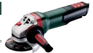
1700 W - première meuleuse d'angle de 1700 watts avec la puissance d'une grande et la maniabilité d'une petite meuleuse pour une abrasion rapide dans les applications industrielles - Ø de la meule 125 mm - Couple de rotation 3,7 Nm - Vitesse de rotation à vide 11000 /min - Vitesse de rotation en charge nominale 11000 /min - Couple de rotation 3,7 Nm - Filet de la broche M14 - Poignée homme mort - Poids sans câble 2,7 kg.
