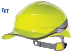
ABS. Coiffe polyamide : 3 bandeaux textiles avec 8 points de fixation. Basane éponge. Ajustable : tour de tête de 53 à 63 cm. 2 positions possibles du tour de tête (haut/bas) pour un meilleur confort. Isolement électrique jusqu'à 1000 VAC ou 1500 VCC. Coloris blanc, bleu, jaune fluo, orange fluo, rouge, vert, noir. CE Cat.II - EN397. Réf. DIAM5JAFL
