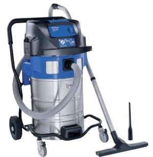
2 turbines BY-PASS hautes-performances - Sécurité surchauffe moteur - Cuve 70 L INOX - Décolmatage semi-automatique - Filtre lavable nano-fibres classe M - puissance 250 mbars - 120 L/s. Réf. 107416602
