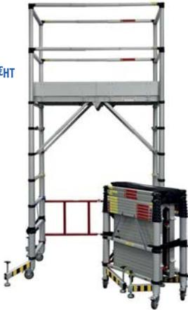
Aluminium anodisé - Ø des montants 44 à 68 mm - 7 hauteurs de travail maxi de 2,33 à 4 m - L 1,50 m x l. 0,80 m, Dim. ext. L 1,55 m x l. 0,92 m, pliées H.1,10 m x l. 0,80 m x ép. 0,45 m - Plancher aluminium, une trappe, plinthes alu amovibles - Surface utile 1,40 x 0,60 m - Charge maxi admissible sur plancher 150 kg - 4 stabilisateurs intégrés et orientables - Roues à frein Ø 100 mm. Décret 2004-924.
