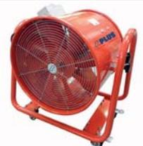
Alimentation 230 V monophasé - Carrosserie en acier peint, deux grilles de protection, pales en aluminium, sécurité moteur, interrupteur de commande. Gaine disponible longueur 10 M.
