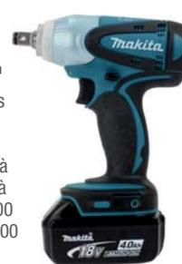
18 V Li-Ion 4 Ah 230 Nm - Temps de charge en moyenne 36 min. Emmanchement carré 1/2". Capacité : boulon standard M10 à M16. Capacité : boulon HR M10 à M14. Vitesse à vide max. 0 à 2100 tr/min. Cadence de chocs 0 à 3200 cps/min.
