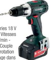
Tension de la batterie 18 V - 2 batteries 18 V 4,0 Ah - moteur 4 pôles - 60 Nm - Vitesses de rotation à vide 0-450/0-1600 tr/min - Couple de rotation tendre 34 Nm - Couple de rotation dur 60 Nm - Couple de rotation réglable 0,7-8 Nm - diam. de perçage dans l'acier/bois 13/38 mm - Filet de broche de perçage 1/2"-20 UNF - Ouverture mandrin 1,5-13 mm - Poids avec batterie 1,8 kg.
