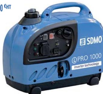
Moteur professionnel essence 4 temps YAMAHA. Technologie INVERTER - Sécurité d'huile. Puissance maxi 2 kW- 2 kVA - 1 prise 1 x 230 V 10/16 A - Disjoncteur + 1 x 12 V 8A - Réservoir 4,2 litres - Autonomie 4,7 h - Niveau sonore 60 dB(A)@ 7 m - Dim. L49xL28xH44,5 cm / Poids 21 kg. Garantie 2 ans.
