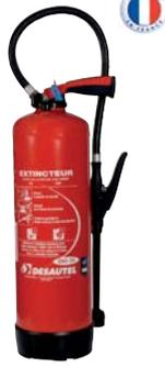
Extincteur NF EN 3.7 Eau pulvérisée + additif AB 9L avec support. Corps acier 20/10°. Résistance au brouillard salin >1000h. Socle de protection évitant la rétention d'eau.
