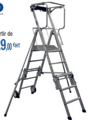
Plancher antidérapant 0,50 x 0,40 m. Plinthes hauteur 100 mm. Charge utile 150 kg. Marches antidérapantes de 60 mm. Tablette outillage + crochet porte-seau. Roues Ø 200 mm non marquantes - Décret 2004-924 / Norme PIRL..
