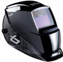
4 capteurs de détection. Champ de vision 100 x 53 mm. Sélection des teintes de soudage et position meulage (teinte 4). Teintes variables 5-8 / 9-13. Temps de réaction : 0,10 ms. Témoin de batterie faible & batterie changeable. Protection permanente UV et IR. CE Cat II - EN 175 - EN379 - Oculaire : 4/5-8/9-13 - 1/1/1/2/EN379 CE - Monture : EN175 B CE. Réf. FUSV
