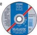
Abrasif corindon A - Dureté R dur - Pour inox - Meulage de surface, usinage des cordons de soudure, chanfreinage, goujures. Meilleurs résultats de meulage sur des meuleuses d'angle puissantes - Alésage 22,23 - Grain A24 - Epaisseur 7mm.
