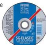
Abrasive corindon A - Dureté R dur - Pour inox - Meulage de surface, usinage des cordons de soudure, chanfreinage, goujures. Meilleurs résultats de meulage sur des meuleuses d'angle puissantes - Alésage 22,23 - Grain A24 - Epaisseur 7mm.
