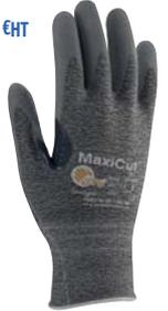
Support tricoté nylon et enduit micro mousse de nitrile. Tailles : 6-11. Normes : CE Cat.II - EN388 (4331). Réf. MXCUT3-450-06
