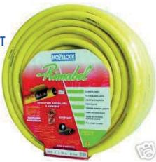
Tuyau tricoté 5 couches avec structure alvéolaire 3Plus. Revêtement PVC souple, couche intermédiaire expansée, renforcement textile tricoté, âme noire bicouche lisse en PVC souple.
