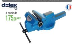
Tête de coulisse forgée - Coulisse prismatique en acier au manganèse h.l.e. - Vis de serrage forgée - Mors rapportés interchangeables en acier au chrome-molybdène, cémentés, trempés - Vis de réglage en laiton - Base tournante en acier estampé à froid.
