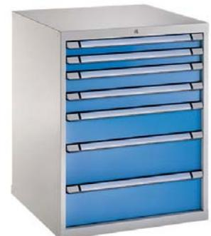
Bâti en tôle d'acier. Fermeture centralisée avec système anti-basculement. Capacité de charge 75kg/tiroir. 7 tiroirs à ouverture totale 100%. Dimensions intérieures du tiroir : L700xP600 mm. Réf. A81.557.000
