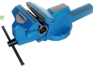
Tête de coulisse forgée - Coulisse prismatique en acier au manganèse h.l.e. - Vis de serrage forgée - Mors rapportés interchangeables en acier au chrome-molybdène, cimentés, trempés - Vis de réglage en laiton - Base tournante en acier estampé à froid.
