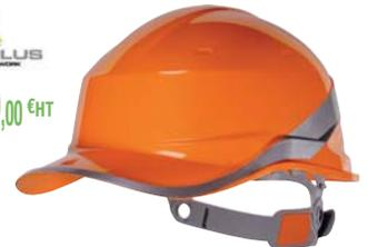
Testé avec visière portée devant ou derrière. Basane éponge. Serrage innovant à bouton «colour to colour». Ajustable : tour de tête de 53 à 63 cm. 2 positions possibles du tour de tête (haut/bas) pour un meilleur confort. Isolement électrique jusqu'à 1000 VAC ou 1500VCC. CE Cat II - EN397 MM LD -20°C +50°C 440 VAC - EN50365 CLASSE 0
