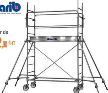
Conforme au décret du 01/09/04 - Norme NF EN 1004 - Longueur 1,50 m - Largeur 0,69 m - Sécurité anti-soulèvement - Charge maxi admissible sur un plancher : 140 kg - Stabilisateur unique pour toutes les hauteurs à réglage millimétrique - Roues diamètre 125 mm réglables sur 20 cm
