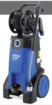
Moteur asynchrone 230V / 50 Hz - Pompe axiale laiton à graissage à vie - enrouleur flexible 15m - Lance 4 en 1 (jet HP 20° + jet HP grand angle 65° + jet BP + Rotabuse)
