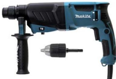
3 fonctions : perçage, perforation et burinage - Puissance de frappe 2,4 Joules, cadence de frappe max. 4600 cps/min - Variateur de vitesse - Limiteur de couple protégeant le moteur ainsi que l'utilisateur en cas de blocage - Mandrins interchangeables à verrouillage rapide (SDSPlus ou autoserrant) - Niveau d'exposition aux vibrations en perforation 15,5 m/s<sup>2</sup> - Poids 2,9 kg - Livré en coffret, avec guide de profondeur et mandrin autoserrant 13 mm à queue SDS-Plus.
