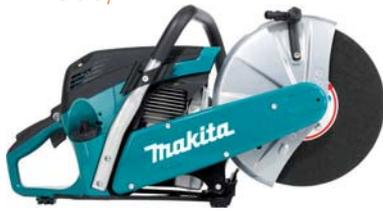
Moteur 2 temps 60,7 cm<sup>3</sup> - Conforme à la norme 2002/88/EC (-20% de consommation d'essence) - Disque Ø 300 mm x alésage 20 mm - Puissance 3,2 kW - Vitesse de rotation 5100 tr/min - Poids 8,5 kg - Livré avec 1 Disque synthétique béton Ø 300 mm x 3,2 mm x 20 mm, et 1 Pochette à outils.
