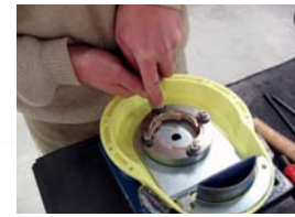
Fig. 4 Vérification des parties mécaniques d'un enrouleur de rappel d'un EPI anti-chute
