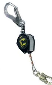
Fig. 9 Enrouleur à rappel automatique avec indicateur de chute (manchons sertis au bout du câble)
