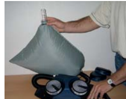
Fig. 3 Contrôle débit d'air d'un masque à ventilation assistée
