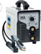
Poste de soudure à l'électrode ultra puissant. Pour électrodes acier, inox, fonte Ø 1,6 à 4 (Ø 3,2 en continu). 10 à 180A max. Alimentation 230V - 320A. Livré en valise avec porte électrode et pince de masse. Aides au soudage intégrées (Hot start, Arc Force, Anti-sticking). Protégé contre les surtensions jusqu'à 400V (Protect 400). Garantie de 2 ans. Réf. 031425
