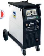
Poste de soudure semi-automatique MIG/MAG. Idéal pour la réparation, la serrurerie ou les ateliers de production semi-industrielle. Courant de soudage de 40 à 350A (270A à 60%). Pour fil acier, inox et alu de Ø 0.8 à 1.2mm. Moto-dévidoir 4 galets intégré / Accueille les bobines de Ø 200 et 300mm. Alimentation triphasée 400V - 16A. Mode synergique : Le générateur détermine automatiquement la vitesse de fil optimale en fonction de la nature et le diamètre du fil. Garantie de 2 ans. Réf. 035928
