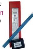
Électrode rutile-cellulosique pour soudage en toutes positions des aciers courants. Très bonne maniabilité et enlèvement de laitier aisé. Utilisable avec des générateurs à basse tension à vide U0. Principales applications : Constructions métalliques, réservoirs, tuyauteries, travaux artisanaux, serrureries.
