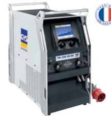
Poste de soudure Inverter TIG AC/DC spécial ALU, acier, inox et cuivre. AC : 10 à 250A ; DC : 5 à 250A. Refroidissement liquide intégré. Amorçage : HF/Lift Gâchette : 2T/4T/4Tlog. Procédés Tig AC/DC : "normal" (standard ou AC Easy)/pulsé (standard ou Easy Pulse)/Spot. Idéal chantier (IP23). Alimentation 400V (PFC intégré). Livré avec kit chariot, torche TIG SR18L 8m, câble pince de masse 4m 25 mm². Idéal chantier (IP23). Garantie de 2 ans. Réf. 035430
