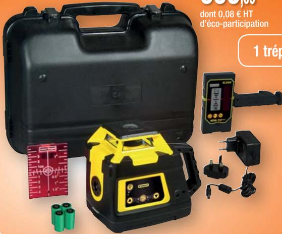
Laser Rotatif RL HW + Cellule de détection avec support + Cible magnétique + 4 batteries NI-MH rechargeables + Chargeur + Malette de transport - Le plus simple de la catégorie - Diode laser: 635nm - classe 2M - Précision: +/- 1,5mm à 30m + Plage d'utilisation: Ø 600m avec cellule - Mise à niveau automatique (horizontale) - IP66 - Garantie 3 ans + 1 an supplémentaire (inscription sur le site stanleyoutillage.fr)
