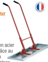
Lissarde TALIASOL avec structure en acier finition époxy - Confort amélioré grâce au réglage de l'inclinaison des bras en 3 positions (40°, 55°, 70°) et au réglage de leur longueur de 740 à 900 mm - Plateau en aluminium pouvant être lesté - Longueur 1,34 m - Largeur 31 cm
