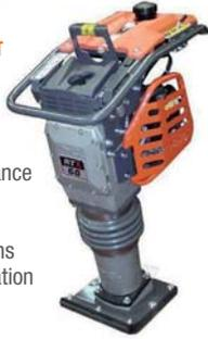
Moteur 4 temps HONDA GX100 - Force de compactage : 16,5 kN - largeur plaque : 280 mm - Puissance 3 ch / 2,3kW - impact sol 450-660 coups/min - 11 Hz - Timon sur amortisseurs (faibles vibrations transmises aux bras) - Triple filtration d'air
