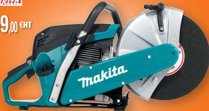
Moteur 2 temps 60,7 cm<sup>3</sup> - Conforme à la norme 2002/88/EC (-20% de consommation d'essence) - Disque Ø 300 mm x alésage 20 mm - Puissance 3,2 kW - Vitesse de rotation 5100 tr/min - Poids 8,5 kg - Livré avec 1 Disque synthétique béton Ø 300 mm x 3,2 mm x 20 mm, et 1 Pochette à outils.
