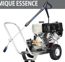
Réf. MC 5M-250/1000 PE - Moteur HONDA GX390 13CV avec sécurité manque d'huile - pompe radiale 3 pistons céramique et culasse laiton - Valve de sécurité surchauffe de pompe - 250 bars - 1000 l/h - lance inox Flexo Power.
