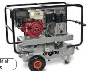
Compresseur thermique essence 7.1 CV - débit 34.2 m<sup>3</sup>/h - 10 bars - cuve 2 x 25 L - dim 1120 x 690 x 610 - 118 kg - Le système "ROLL BAR" protège complètement le compresseur et facilite la manutention
