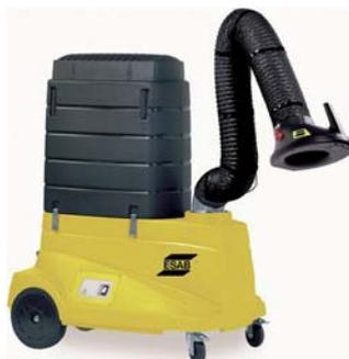
Aspirateur de fumée de soudage mobile avec 1 bras de 3 m. Filtre cartouche 35 m<sup>2</sup> en cellulose jetable. Efficacité >99 % EN 15012-1 Débit d'air maxi = 1050 m<sup>3</sup>/h à la hotte. Bras de 3 mètres, diamètre 160 mm, modèle sans éclairage.
