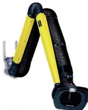
Le bras est relié à un ventilateur et un filtre mural qui extrait les contaminants de l'air pour offrir un environnement sûr et fiable aux soudeurs pendant les travaux de soudage. Il est disponible en longueur 2 et 3 mètres. Il est équipé d'un clapet dans la hotte qui ouvre et ferme les raccordements à chaque point d'extraction afin d'améliorer l'efficacité et les coûts d'opération.
