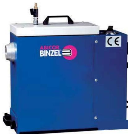
Tension d'alimentation 230V. Puissance moteur 110 W. Dépression maxi 190 mbar. Débit maxi 200 m<sup>3</sup>/h. Poids 26 kg. Niveau sonore 71dB. Aspirateur de conception solide et compacte. Fonction marche/arrêt automatique pour réduire la consommation d'énergie. Nettoyage du filtre intégré. Faible niveau de bruit. Livré avec tuyau et raccords. Equipé pour évacuation de l'air vers l'extérieur ou dans un réseau centralisé.
