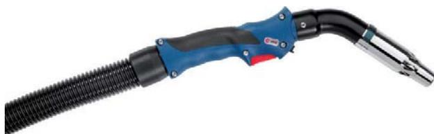
Torche à aspiration des fumées refroidie par air avec buse réglable. Puissance de 300A sous CO<sup>2</sup> et de 270A sous mélange gazeux. Facteur de marche de 60%. Ø fil 0,8-1,2mm.
