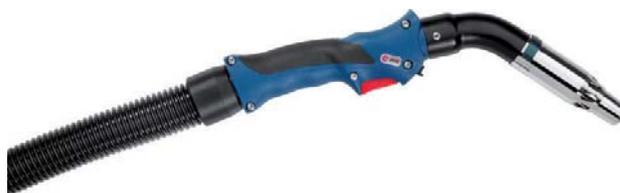
Torche à aspiration des fumées refroidie par liquide avec buse réglable. Puissance de 300A sous CO<sup>2</sup> et de 270A sous mélange gazeux. Facteur de marche de 100%. Ø fil 0,8-1,2mm.
