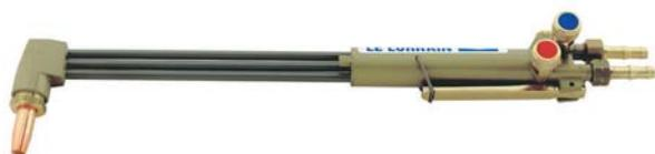
Tous les chalumeaux coupeurs haute pression de type HP1 fonctionnent sur le principe du mélange de l'oxygène et du gaz combustible dans la tête. Ce type de mélange assure à l'utilisateur une minimisation des rentrées de flamme. Il existe 2 sortes de cônes : le type HP1 standard en France et le type IC cône international.
