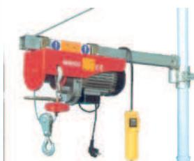
Puissance 900 W. Les moteurs/réducteurs sont fabriqués en Europe, la gamme est destinée à des applications industrielles mais également à des utilisations dans des magasins où l'alimentaire - Fin de course standard - Commande boîtier - capacité 1 brin 250 kg longueur câble 12m - capacité 2 brins 500 kg longueur câble 6 m.
