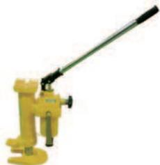
Cric hydraulique 360° hydrojack 5T, capacité 5 T, course 205 mm, hauteur mini sur le sabot 25 mm, hauteur mini sur la tête 368 mm, effort à appliquer sur le levier (n) 380, températures d'utilisation de -20 °c à +50 °c.
