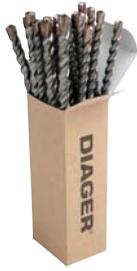
FORETS SDS-Plus BOOSTER+ pour marteau perforateur, Plaquette carbure monobloc 3 taillants avec pointe auto-centrante, l'hélice carrée accélère la remontée des poussières et augmente la durée de vie, calibre parfait des trous. Boîte de 12 pces
