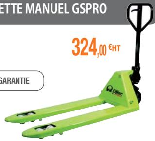
Robuste et particulièrement manœuvrable sur tout type de surface. Une soupape de protection bloque le levage des fourches en cas de surcharge. Peinture époxy haute qualité. Roues directrices Ø 200 mm à bandage caoutchouc sur jante acier et boogies polyuréthane Ø 82 mm. Capacité de charge : 2500 kg. Hauteur de levée mini/maxi : 85/115 mm. Dimensions des fourches : 1150 x 525 mm. Poids : 63 kg. Réf. 5D1190030 B/N
