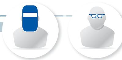
Les lunettes sont principalement utilisées pour protéger vos yeux de la lumière de la flamme au cours d'opérations de soudage ou coupage, ou de risques mécaniques par exemple lors du meulage.
