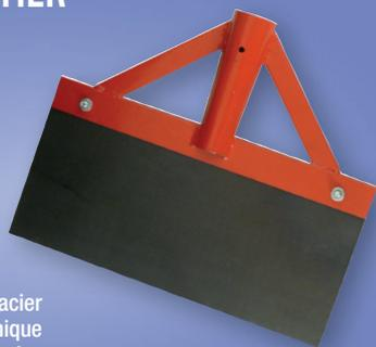
Grattoir de chantier lame vissée en acier trempé 38 HRC. Emmanchement conique 35 mm. Lame : 1,5 mm. Largeur de la lame : 300 mm Hauteur de la lame : 12 cm.
