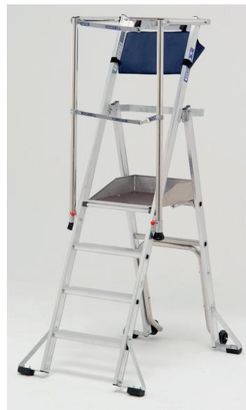
Rapport qualité/prix imbattable - Montage 100% sécurité - Légère : facile à déplacer et à transporter - Rangement porte-outils multi-fonctions - Passage libre - Plate-forme large de 400 x 500 mm - Stabilisateurs base évasée, pas de stabilisateur jusqu'à 5m - Norme 93 353 - Décret 2004-924 - Charge maxi : 150 kg - Encombrement replié minimum - Légèreté : de 10 à 16 kg selon le modèle.
