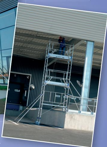
Usage ultra intensif - Aluminium - Utilisation sur sol plat et dénivelé - Plateau 1,79 x 0,66mm - Encombrement au sol 2,11 x 0,90m - Charge maxi 200 kg/m<sup>2</sup> - Montage en sécurité totale, sans outils ni vis - Roues de Ø 200 mm - Plinthes aluminium résistantes et mise en place ultra facile - Label NF - Norme EN 1004 - Réglementation R547 - Décret 2004-924 - Garantie 5 ans.
