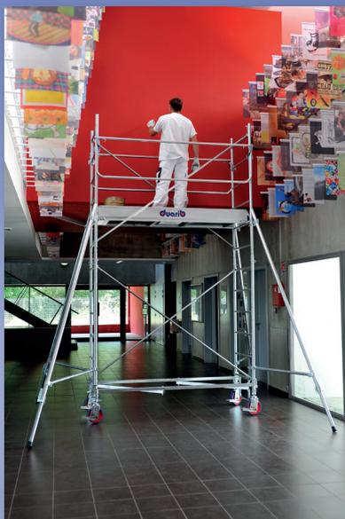
Acier galvanisé - Décret 2004-924 / Norme NF EN 1004 - Label NF - Possibilité de réhausse jusqu'à 13,6m hauteur de travail - Largeur : 0,75 m - Base pliante en parallélogramme - Montage et démontage en sécurité par un opérateur - Plancher Alto alu/bois - Double trappe - Plinthes intégrées - Charge max sur plancher 230 kg - 4 stabilisateurs ajustables à hauteur - Roues ø 200 mm réglable sur 20 cm - Installation en dénivelés maxi de 1,50 m - Assemblage par soudure - Fabrication française.
