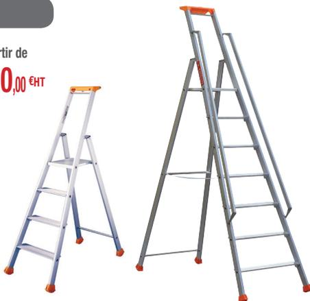
Usage ultra intensif - Montants anodisés - Repose pied 280 x 250mm en fonte d'aluminium antidérapant - Marches 90 mm - Evasement du plan de montée pour une excellente stabilité - Porte-outils avec logement pour vis avec couvercle - Sécurité antibasculement 650mm - Charge maxi 150kg - Norme EN131 - Décret 96333 - Label NF - Garantie 5 ans.
