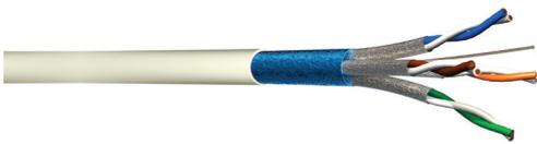
Câble Grade 3 TV F/FTP 4 paires 500MHz/2.2GHz, avec bande passante 2.2GHz sur paire 7/8 et gaine LSZH conforme RPC Dca s2 d2 a2.
