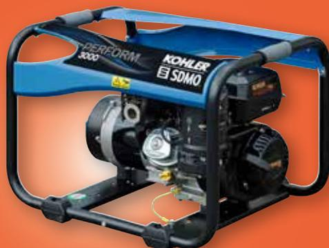
Moteur essence sans plomb KOHLER OHV CH 270 refroidi par air, démarrage au lanceur, garantie 3 ans, fabriqué en France. Châssis compact avec bandeaux antichoc, réservoir 4,1 L, autonomie 3,2 h, sécurité huile, niveau sonore 67dB(A) 7m, 45 kg. Options possibles : kit brouette, kit entretien.
