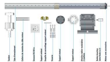
Kits Tradi (pour coffre tunnel et menuisé). Un tube aluminium télescopique (octogonal 70 mm) équipé du moteur radio dernière génération RS100. Un point de commande radio. Les accessoires mécaniques permettant de fixer la tête moteur et le tube aux supports tabliers existants : sangles, attaches, agrafes, embouts... Les accessoires électriques : kit de visserie, notice...
