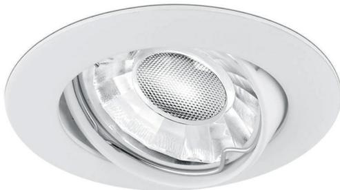
Kit encastré à encastrer LED pour la rénovation. Corps thermoplastique. Remplacement des projecteurs encastrés traditionnels. Réglage - / + 30 °. Fixation de lampe à anneau. Pack fourni avec une lampe ICE™ GU10 4W. Angle de faisceau de 60 ° pour une distribution lumineuse accrue. Garantie de 3 ans.
