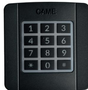
Clavier à code radio 12 touches d'extérieur, 433,92MHz avec rétroéclairage bleu, 25 codes mémorisables et mot de passe d'accès à la programmation. Réglable en mode code tournant ou code fixe. Gris RAL 7024.
