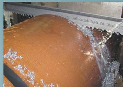
Pour une découpe efficace des matériaux difficiles et abrasifs. Dent à triple déport et bon espace de lame pour éviter la perte de dent. Augmente considérablement la production. Prolonge la durée de vie de la lame. Même lame que TSS sans affilage. Idéale pour les coupes exigeant une lame tranchante. Parfaite pour la coupe des alliages de titane, d'aluminium et de silicium ou des alliages moulés.
