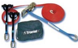
TEMPO 2. Ligne de vie temporaire en sangle, simple et rapide de mise en œuvre elle autorise la mise en sécurité de 2 utilisateurs simultanément longueur maximum 18 mètres, tension par système a cliquet, sa mise en place s'effectue lorsque l'on dispose de 2 points.
