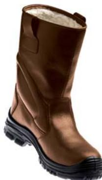
Coquille de sécurité en COMPOSITE, semelle anti-perforation Wellmax® COMPOSITE, doublure fourrée, tige en cuir de buffle pleine fleur marron clair imperméable, semelle en polyuréthane double densité. Utilisation, froids et hiver, milieux glissants, milieux pétroliers, milieux humides, manutention d'objets lourds, industries, stockage. EN ISO 20345+ A1:2007. CLASSE S3-SRC.
