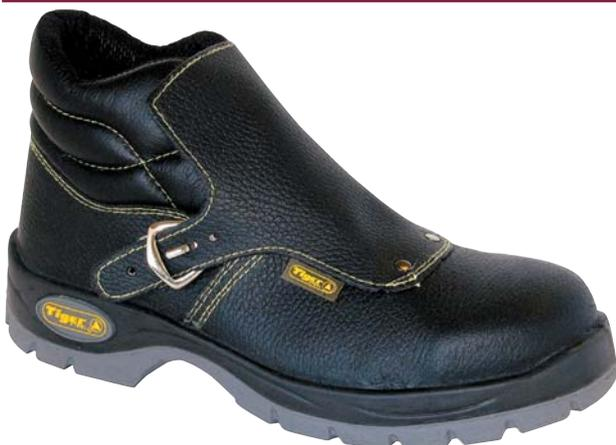
Tige haute avec rabat en cuir croupon pigmenté. Doublure croûte de cuir. Première de propreté (amovible). Dessus coton sur Eva. Semelle injectée, polyuréthane bi-densité. Semelle anti-perforation et embout de protection résistant aux chocs et à l'écrasement (200 J). Talon absorbeur d'énergie. Semellage résistant aux hydrocarbures. Protecteur antistatique. Semelle résistante aux glissades sur sols industriels lisses et gras.
