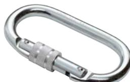
Connecteur pour connexions permanentes, verrouillage manuel par vis ouverture 18mm acier bichromate, mise en place possible par l'utilisateur sur une longe.
