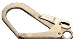
Connecteur pour connexions fréquentes sur structure, verrouillage automatique par double gâchette, ouverture 50 mm acier bichromate. Conforme à la norme EN362.
