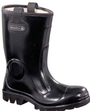
Botte de sécurité série RAIN BOOT. Tige PVC bi-injection. Doublure fourrure polyester. Première de propreté fixe avec protection aluminium. Semelle PVC - Nitrile à crampons - Semelle Acier S5. Tirettes de chaussage. Coloris Noir.
