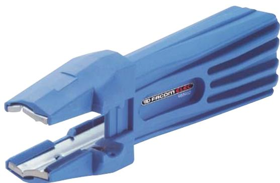
Idéal pour le dégainage des câbles au fond des boîtes d'encastrement. Dégainage de 4 à 13 mm, dénudage de 0,5 à 16 mm, câbles coaxiaux de 4 à 8 mm. Dénudage et dégainage sans réglage.
