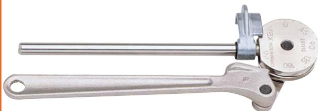
Pour tube cuivre écroui et recuit :  $\varnothing$  6 à 18 mm, épaisseur 1 à 1,2 mm. Angle de cintrage : jusqu'à 180°. Graduation de 0 à 180°. Manche en acier. Gorge usinée.
