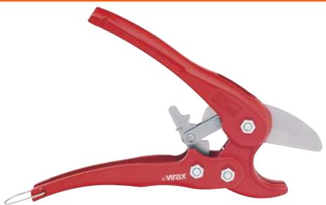
Crémaillère de démultiplication de l'effort. Coupe-tube utilisé pour la coupe rapide des tubes en PVC, PP, PE, PER, ABS, PEHD jusqu'à 26mm. Lame traitée pour une coupe d'équerre et sans bavure.
