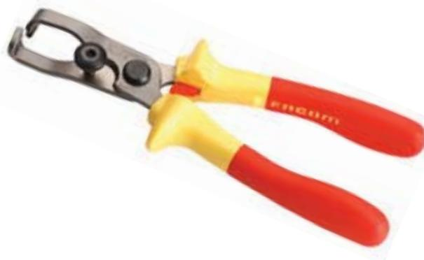
Isolée 1000 V. Pour fils multibrins ou monobrins de 0,5 à 6 mm<sup>2</sup>. Pince standard forgée. Vis de réglage moletée avec contre-écrou. Ressort de rappel métallique.
