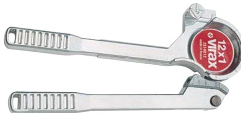
Pour tube cuivre écroui et recuit :  $\varnothing$  8 à 16 mm, épaisseur : 1 à 1,2 mm. Angle de cintrage jusqu'à 180°. Corps en alliage léger, arrondi permettant l'appui du genou.
