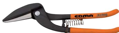
Spéciale pour longue coupe droite. Tranchants traités par induction. Dureté des lames 57 - 59 HRC. Ressort inclus et amovible. Capacités de coupe : INOX : 1,2 mm et ZINC : 1,8 mm.
