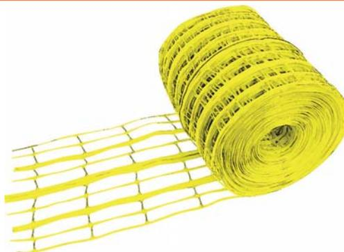
Pour identification des canalisations enterrées lors des fouilles. En polyéthylène teinté masse, conforme à la norme EN 12613 et agréé par le CNET, EDF et GDF. Prédécoupe des brins facilitant la visualisation lors de l'extraction. Emballage unitaire sous film opaque anti U.V. Rouleaux de 100 m. Largeur 30 cm.
