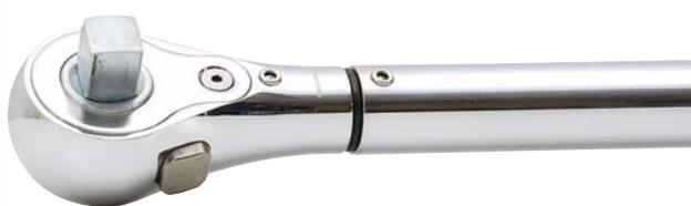
Clé dynamométrique à déclenchement 1 déclic signale que le couple est atteint (1 dent saute). Tête à cliquet réversible - dynamométrie dans les deux sens. 72 dents - Angle de reprise 5°.
