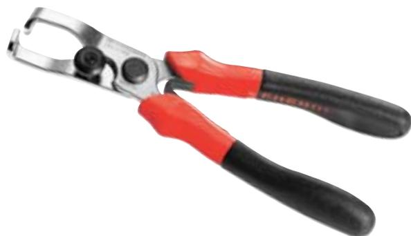
Pour fils multibrins ou monobrins de 0,5 à 6 mm<sup>2</sup>. 194.17 : Pince standard forgée. Vis de réglage moletée avec contre-écrou. Ressort de rappel métallique.
