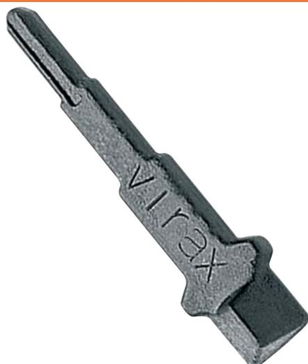
Ø 3/8"-1/2"-3/4", destinée au montage des raccords à écrou prisonnier qui assurent la liaison entre le radiateur et son robinet de réglage. carré d'entraînement de 18 mm. outil en acier forgé.
