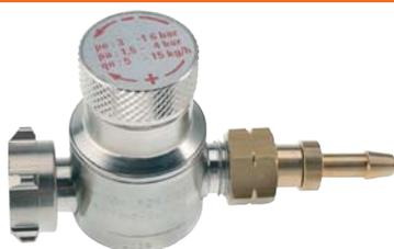
À pression réglable en continu de 1,5 à 4 bar. - En version NF avec raccords conformes à la norme nf en 560. Livré avec un raccord à tétine Ø 6 mm.
