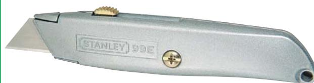
Corps en alliage de zinc, très résistant et léger. Système interLock de blocage de la lame, pour prévenir le soulèvement du couteau, même sous forte pression. Chariot porte-lame métallique à 5 positions. Blocage total de la lame même pendant les coupes difficiles. Pour gauchers et droitiers. Bouton poussoir arrondi. Réservoir de lame à l'intérieur du manche. Livré avec 3 lames de rechange.
