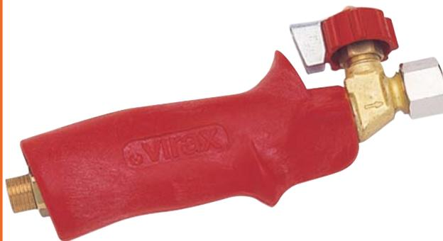
Réglage progressif de la flamme par robinet "coup de pouce". - Mamelon fileté pour montage des raccords droits ou tournants au filetage M 16 x 1,5 G pour la France et 3/8" G pour les autres pays. - Poignée ergonomique. - Gamme de 6 lances interchangeables.
