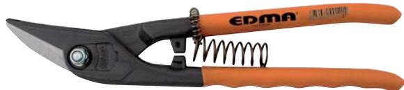
Cisaille coupe trou. Capacités de coupe : - 1 mm : Inox - 1,5 mm : Zinc. Tranchants traités par induction. Dureté des lames 57 - 59 HRC. Ressort inclus et amovible. Poignées isolantes (thermique).
