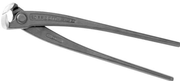
ISO 9242, DIN ISO 9242, NF ISO 9242. Branches semi-rigides, arrondies pour une rotation rapide dans la main. Longue durée de vie des taillants traités "Haute Fréquence à 60/62 HRC. Capacité de coupe des taillants : Jusqu'à diam. 4,5 mm sur fil doux pour la 300 mm. Max. sur fil dur 160 kg/mm<sup>2</sup>. Présentation : brunie, tête polie.
