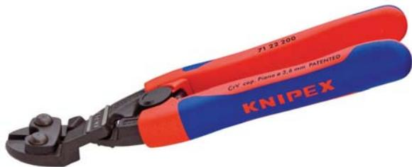
Jusqu'à Ø 3,6 mm et fils pleins doux (Ø >6 mm), boulons, clous, rivets, vis. Moins d'effort grâce à la transmission de force par articulation, avec ressort à l'intérieur, becs coudés à 20°. Gainage bi-matière.
