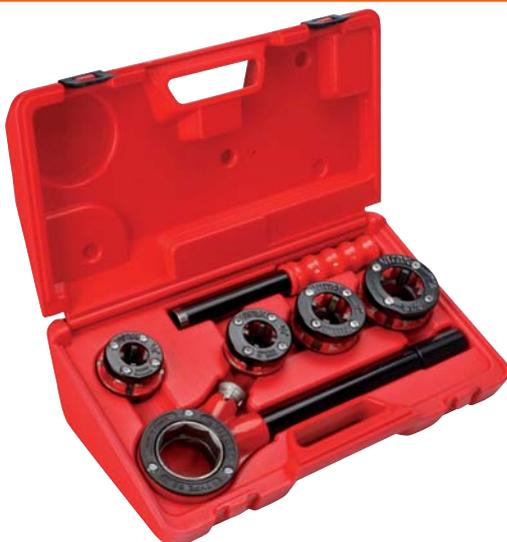
Contenu : Bras 2 parties cliquet + 4 filières (1/2"-3/4"-1"-1 1/4"). Bras en tube acier. Cliquet réversible droite-gauche pour une plus grande maniabilité. Poignée ergonomique. Mise en place et extraction aisée des têtes.
