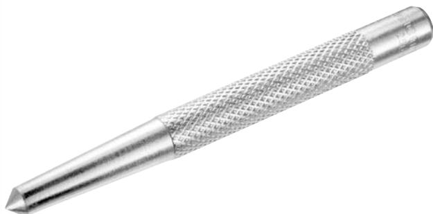
Poinçon de précision - Ø 2,5 mm NF E 71-211. Forgé dans un acier au chrome-vanadium, dureté de 52 à 58 HRC.
