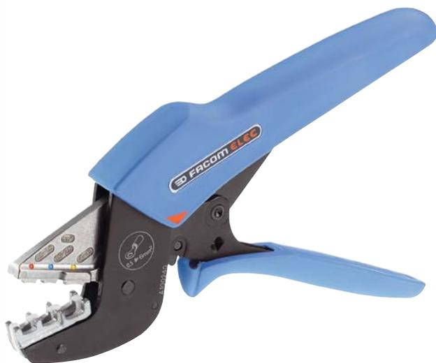
Pour cosse pré-isolées. Maintien automatique de la cosse et du câble. Double sertissage avec repérage de la matrice sur l'isolant, de 0,5 à 6 mm<sup>2</sup>.
