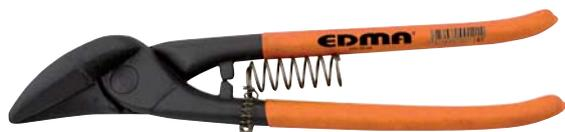
Cisaille passe-franc 260 mm coupe à droite; Capacités de coupe : - 1 mm : Inox - 1,5 mm : Zinc. Tranchants traités par induction. Dureté des lames 57-59 HRC. Ressort inclus et amovible. Poignées isolantes (thermique).
