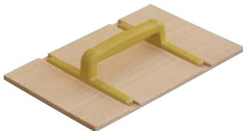
Bois exotique. Épaisseur : 15 mm. La poignée ergonomique en polypropylène injection gaz azote est interchangeable. Elle est montée sur le plateau par un système de double queue d'aronde. Livrée avec clip de brochage.
