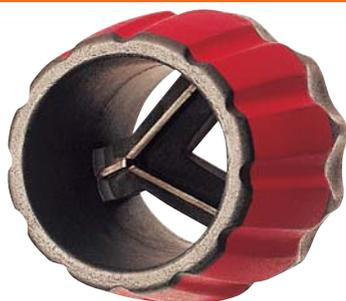
Pour tubes PVC, PEHD :  $\varnothing$  6 à 42 mm - 1/4" à 1.5/8" et tube cuivre. Ébavureur intérieur / extérieur. Corps en polypropylène résistant aux chocs et au froid.
