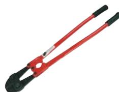
Coupe tous les aciers jusqu'à 125 kg/mm<sup>2</sup>. Mâchoires en acier forgé à très haute résistance. Supports mâchoire, boulons d'articulation et boulons à came en acier forgé. Traitement à haute résistance. Bras tube laqués rouge. Réglage des mâchoires par excentrique. Coupe acier dur 6 mm de diamètre – acier doux 8 mm de diamètre.
