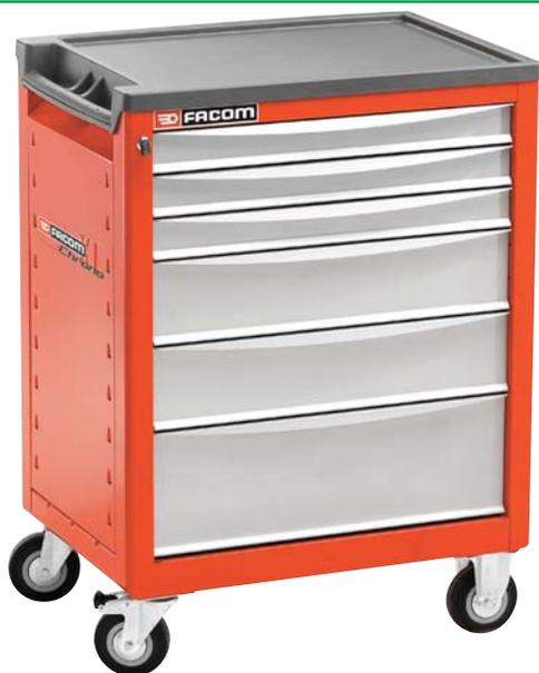
Composition de tiroirs : 3 x 60 + 2 x 130 + 1 x 200 mm. Dimensions hors tout (roues et plan de travail compris) : L. 735 x P. 510 x H. 970 mm. Dimensions utiles des tiroirs : L. 569 x P. 421 x H. 60/130/200 mm. Charge par tiroir : 20/20/25 kg. Couleur : caisson en rouge 3020 et tiroirs en gris 9006. 69 kg.
