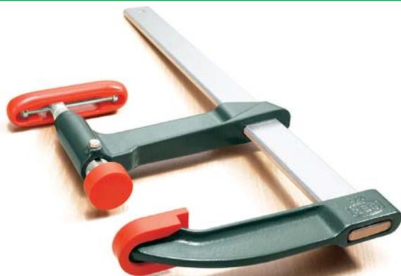
Rail en acier. Valet et coulisseau en fonte de haute résistance. Frein de blocage du coulisseau sur le rail. Protections aux mors de serrage. Puissance de serrage jusqu'à 12.000 N. Poignée confort amovible.
