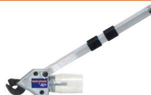
Adaptateur pour perceuse avec ou sans fil de 14,4 V et 2 A minimum. Coupe rapide et sans effort. Découpe facile d'une seule main. Capacités de coupe : GALVA 1,4 mm, INOX 0,9 mm, CUIVRE 1,4 mm et Aluminium 1,6 mm.
