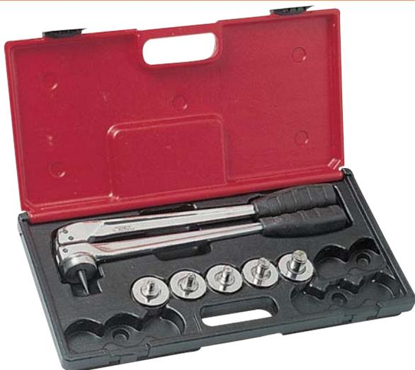
Contenu : pince + 5 têtes (Ø12,14,16,18,22mm). Effort réduit grâce au mécanisme de démultiplication performant, aux bras de manoeuvre longs et rigides, à l'aiguille cônica d'expansion, des outils d'expansion. Pince très résistante grâce à des bras profilés.
