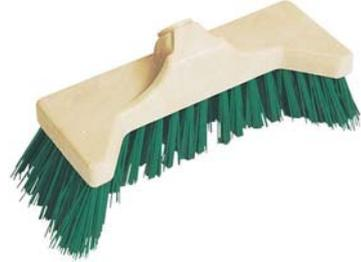
Monture en polypropylène très résistante. Profil spécialement étudié pour concentrer les déchets et réduire le nombre de passages. Douille monobloc incorporée. Fibras PVC vert diam. 12/10, longueur 11 cm. Fibras implantées à 115° permettant une plus grande largeur de balayage. Manche vendu séparément.
