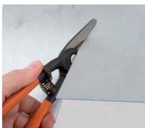
Cisaille lame large et lame étroite. Capacités de coupe : INOX : 1 mm - ZINC : 1,2 mm. Multidirectionnelle. Dureté des lames 57-59 HRC. Ressort inclus et amovible.
