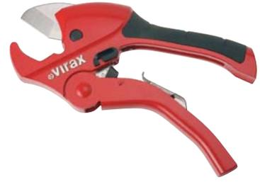
Crémaillère de démultiplication de l'effort. Coupe-tube utilisé pour la coupe rapide des tubes en PVC, PP, PE, PER, ABS, PEHD jusqu'à 42 mm. Lame traitée pour une coupe d'équerre et sans bavure.
