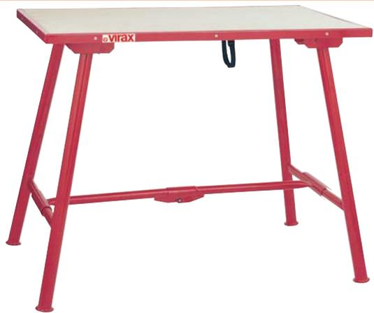
Plateau en bois multiplis avec cadre en cornière métallique. Piètement en tube de Ø 40 mm. Facile à monter et à démonter. Construction très robuste pouvant supporter des poids élevés. Dim. plateau 180 x 840 x Ép. 32 mm, H 840 mm. Poids 25 kg.
