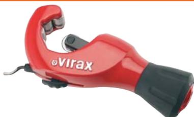
Épaisseur maximum 2 mm. Pommeau SOFT TOUCH® à avance/retour rapide et antidérapant. Changement de molette rapide et sans outil. 1 molette de rechange. Ébavureur rotatif rétractable à lame interchangeable.
