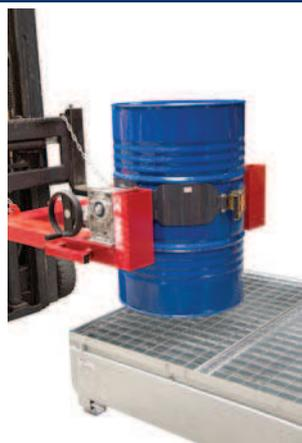
Retourneur de fûts métalliques permettant de lever, vider et transporter des fûts de Ø 600 mm. Système de serrage par ceinture métallique avec tendeur à crochet et sangle largeur 50 mm. Commande par volant.
