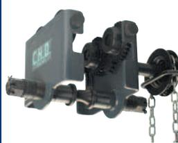
Le C.H.D.D permet d'accompagner la charge en déplacement sur son fer de roulement grâce à une chaîne de manœuvre. L'écartement des flasques est réglable. Ses galets profilés en acier permettent aux chariots de rouler sur tous les types de fer en I ou en H. Chaîne de manœuvre longueur 2,5 m. VERLINDE OU ÉQUIVALENT.
