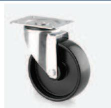
Roulette pivotante - chape zinguée - pivot sur double rangée de billes - axe boulonné - Ø 125/40 roue polypropylène noir - moyeu roulement rouleur - à platine entraxe 60 x 80 - capacité de charge 125 kg.
