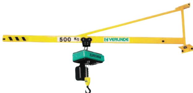
La potence VAT murale triangulée offre un angle de rotation de 180°. Portée 3 mètres. L'orientation est faite sur bague à rotule. Finition peinture polyuréthane jaune RAL 1028. Charpente groupe FEM 2 m. Ligne d'alimentation + sectionneur : Nous consulter. Butée de rotation : Nous consulter. Portée de 2 m à 6 m : Nous consulter. Fabriqué en France.
