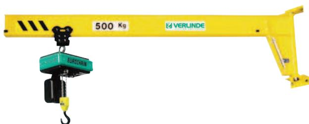
La potence murale VAI permet un angle de rotation de 180°. Portée 3 mètres. La rotation s'effectue sur bague à rotule. La flèche est en profilé IPE. Le renfort inversé apporte un gain de place en hauteur. Finition peinture polyuréthane jaune RAL 1028. Ligne d'alimentation + sectionneur : Nous consulter. Butée de rotation à souder : Nous consulter. Portée de 2 m à 6 m : Nous consulter. Fabriqué en France.
