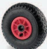
Roue gonflable - corps de roue polypropylène - bandage pneumatique 4 plis - dessin pavé - Ø 260 - axe de 20 - roulement rouleau - longueur de moyeu 74.
