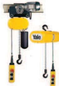
Palan électrique à chaîne CPSF. 2 vitesses de levage, 1 brin. Palan complet fixe à crochet 400 V 50 Hz tri, protection IP54, protection thermique moteur, circuit de commande en basse tension de sécurité 48 V, arrêt d'urgence, chaîne de charge zinguée, FEM 2 m.
