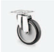
Roue polyuréthane - chape zinguée - bandage polyuréthane - fixation centrale - platine - capacité de charge de 40 à 60 kg.
