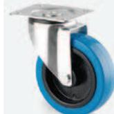
Roulette pivotante SANS frein. Chape zinguée. Pivot sur double rangée de billes. Axe boulonné. Bandage caoutchouc élastique bleu. Roulement rouleau. A platine entraxes 60 x 80. Capacité de charge de 160 à 250 kg selon le diamètre.
