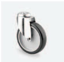
Roulette pivotante SANS frein - chape zinguée - Ø 75 - bandage polyuréthane - fixation centrale - œil de 11 mm - capacité de charge 60 kg.
