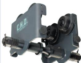
Le C.H.D. est un chariot porte palan qui permet de déplacer la charge par poussée. L'écartement des flasques est réglable. Grâce à ses galets en acier profilés, le chariot roule sur tous les types de fer en I ou en H.
