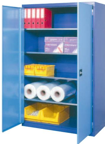
Bâti en tôle d'acier. Portes battantes avec serrure de sécurité 2 points et angle d'ouverture 115 degrés. Tablettes galvanisées réglables par pas de 25 mm. Capacité de charges 100 kg par tablettes. Capacité de charge totale : 500 kg. Différentes dimensions.
