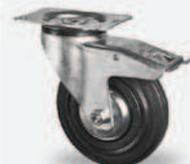
Roue caoutchouc standard - chape zinguée - pivot sur double rangée de billes - axe boulonné - Ø 100 bandage caoutchouc semi-élastique - parefil métallique - à platine entraxe 60 x 80 - capacité de charge 75 kg.
