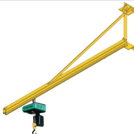
La potence VATS est une potence triangulé (solution économique) en profil creux EUROSYSTEM. Portée 3 mètres. L'orientation de 180° est faite sur bague à rotule. Le chariot intégré apporte un confort supplémentaire d'utilisation. Finition peinture polyuréthane jaune RAL 1028. Charpente groupe FEM 2 m. Ligne d'alimentation + sectionneur : Nous consulter. Butée de rotation à souder : Nous consulter. Portée de 2 m à 6 m : Nous consulter. Fabriqué en France.
