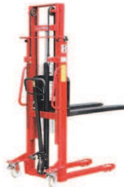
Gerbeur manuel - Levée manuelle hydraulique dernière génération : effort minimum - Vérins hydraulique équipé d'une valve interdisant la levée en cas de surcharge - Limiteur de débit pour la descente - capacité 1000 kg - élévation mini/maxi 90/1600 mm - fourches 1150 x 560 mm.
