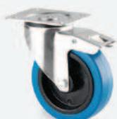
Roulette pivotante AVEC frein - chape zinguée - pivot sur double rangée de billes - axe boulonné - bandage caoutchouc élastique bleu - roulement rouleau - à platine entraxes 60 x 80 - capacité de charge de 160 à 250 kg selon le diamètre.
