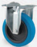
Roulette fixe - chape zinguée - axe boulonné - corps de roue polyamide - bandage caoutchouc élastique bleu - moyeu roulement rouleau - à platine entraxe 60 x 80 - capacité de charge de 160 à 250 kg.
