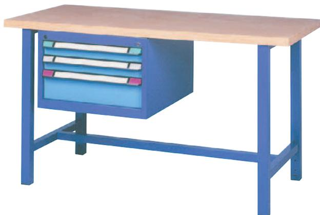
2 piètements en tube d'acier 50/50 mm. Plateau en hêtre multiplis épais. 40 mm. Bâti en tôle d'acier L605 x P695 x H400 mm. Fermeture centralisée avec système anti-basculement. 3 tiroirs (2 x H75, 1 x H150 mm). Capacité de charge 75 kg / tiroir. Différentes dimensions.
