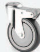
Roulette pivotante avec frein, monture acier, roue avec moyeu roulement à billes, bandage caoutchouc, fixation œil, capacité de charge de 70 à 80 kg.
