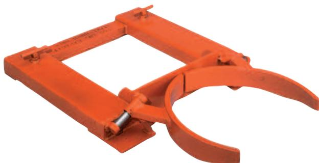
Pince automatique pour fût métallique exclusivement, entièrement mécano soudée très robuste. Modèle breveté. Se monte sur un chariot élévateur. Pince équipée de bras à ouverture automatique, fermeture lors de la levée du fût.
