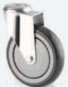
Roulette pivotante, monture acier, roue avec moyeu roulement à billes, bandage caoutchouc, fixation œil, capacité de charge de 70 à 80 kg.
