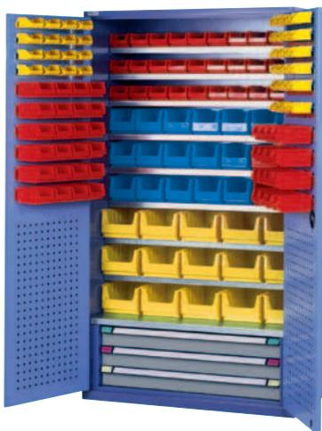
Bâti acier. Portes bat. Serrure 2 pts, ouverture 180°. 9 tab. galva réglables. Charge 100 kg. 3 Tir. H100 mm, ouverture 100 %, Charge 75 kg/tiroir. 146 bacs (40 : L103 x P93 x H52, 70 : L103 x P168 x H76, 21 : L149 x P233 x H121, 15 : L209 x P343 x H145). Charge totale 500 kg. Dim : L1100 x P620 x H1950 mm. Différentes dimensions.
