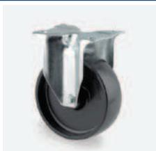
Roulette FIXE - chape zinguée - pivot sur double rangée de billes - axe boulonné - Ø 125/40 roue polypropylène noir - moyeu roulement rouleur - à platine entraxe 60x80 - capacité de charge 200 kg.
