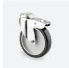
Roulette pivotante AVEC frein - chape zinguée - Ø 75 - bandage polyuréthane - fixation centrale - œil de 11 mm - capacité de charge 60 kg.
