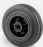
Roue avec corps de roue polypropylène noir - bandage caoutchouc semi élastique noir - Ø 200/50 - roulement rouleau - axe de 20 - longueur de moyeu 58.
