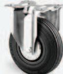
Roue caoutchouc standard - chape zinguée - pivot sur double rangée de billes - axe boulonné - Ø 100 bandage caoutchouc semi-élastique - parefil métallique - à platine entraxe 60 x 80 - capacité de charge 75 kg.
