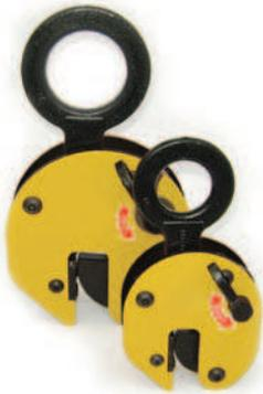
Levage de tôles durété maxi 300 brinell / verrouillage de sécurité / mors acier haute durété pour pincement optimal. CMU de 500 kg à 12 T selon modèle.
