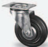
SANS frein - roue caoutchouc standard - chape zinguée - pivot sur double rangée de billes - axe boulonné - Ø 100 bandage caoutchouc semi-élastique - parefil métallique - à platine entraxe 60 x 80 - capacité de charge 75 kg.
