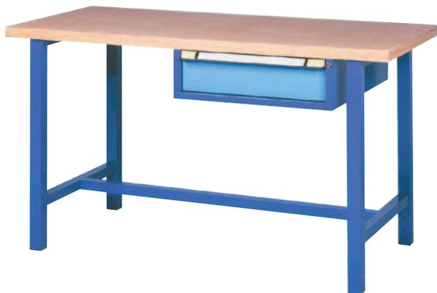
2 piètements en tube d'acier 50/50 mm. Plateau en hêtre multiplis épais. 40 mm. Bâti en tôle d'acier L605 x P695 x H180 mm. Fermeture centralisée. 1 tiroir H150 mm. Capacité de charge 75 kg / tiroir. Différentes dimensions.
