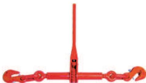
Acier forgé traité, interdit en levage, uniquement arrimage engins TP. Rupture de 8 T à 32 T selon Ø de la chaîne.
