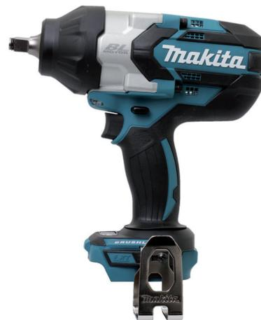
Emmanchement carré 1/2", Couple de serrage max. (franc) 1000 Nm, Boulon M12 à M30, Boulon HR M10 à M24, 1 800 tr/min, 0 à 2200 cps/min, (L x l x h) 229 x 91 x 289 mm, EPTA 3,6 kg
