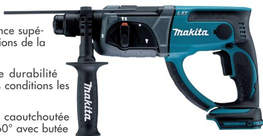
Puissance de frappe (EPTA) 2 Joules, Ø béton/acier/bois 20 / 13 / 26 mm, 0 à 4000 cps/min, 1 200 tr/min, (L x l x h) 358 x 104 x 235 mm, EPTA 3,5 kg
