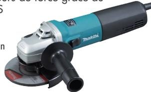
1400 W, Prise en main Ø 210 mm, 12000 tr/min, alésage 22,23 mm, (LxIxh) 299x139x103 mm, EPTA 2,3 kg
