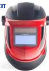
Combine une cellule électronique adaptée au soudage à l'arc, MIG/MAG et TIG et une large visière incolore pour les applications de meulage - Variable DIN 9 à 13 - 4 capteurs d'arc - Vision Latérale 160°. Réf. GT38S4
