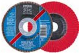
Disque bombé Ø 125 mm support fibre de verre, avec le nouveau grain céramique profilé calibré, sur toile résistante, poudrage fermé, liant résine, traitement anti-échauffement.
