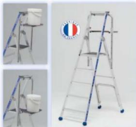
Aluminium - Utilisation sol plat - hauteur d'accès maxi 2,50m - dimensions L 965mm x l 300mm - h 460mm - marches 100mm rivetées - plateau équipé de bandes rugueuses antidérapantes - verrou de sécurité manuel - modèle repliable pour le stockage - Garantie 2 ans. Réf. 02374350
