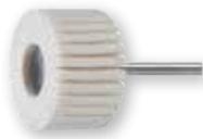
Les feutres à lamelles sur tige sont utilisés avec de la pâte à polir pour le polissage préliminaire et le polissage très brillant sur des éléments de construction de taille petite et moyenne. Grâce à la conception des lamelles l'outil de polissage s'adapte parfaitement aux contours de la pièce à usiner. La contrainte thermique de la pièce à usiner est considérablement réduite. Conditionnement par 5 pièces
