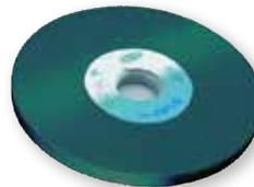
Meule VERTE : pour CW : carbure de silicium . Grain 46-60 : Ebauche. Grain 80 : 1/2 finition. Grain 120 : Finition
