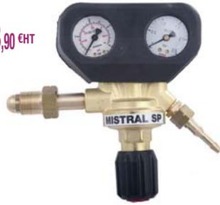
Construit suivant les spécifications de la norme NF-EN ISO 2503, le Mistral SP est un manodétendeur industriel ou de chantier pour tous travaux de soudage, chauffage, formage et d'oxycoupage. Manomètres Ø50mm. Bonnette de protection en caoutchouc auto-extinguible.
