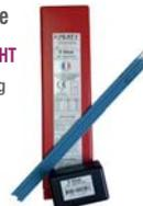
Électrode rutile-cellulosique pour soudage en toutes positions des aciers courants. Très bonne maniabilité et enlèvement de laitier aisé. Utilisable avec des générateurs à basse tension à vide U0. Principales applications : Constructions métalliques, réservoirs, tuyauteries, travaux artisanaux, serrureries.
