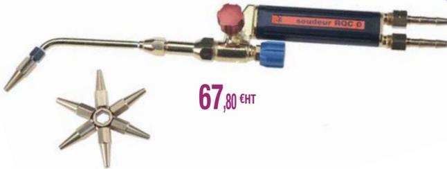
Les chalumeaux ROC 0 sont fabriqués selon la norme ISO 5172 avec les meilleurs matières premières alliant à la fois la qualité et la performance avec la légèreté et la maniabilité. Le corps et les pièces arrières sont en laiton matricié à chaud, le manche est en polycarbonate auto-extinguible, Tube en inox, assemblage avec de la brasure argent.
