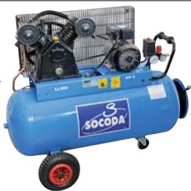
Compresseur à entraînement par courroie bicylindres en V jumelés mono étage. Réservoir : 100 L. Puissance 3 CV. Volume engendré : 24 m³/h. Débit réel à 8 bar : 17 m³/h. Réf. S27/100V
