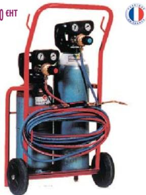
Composition : 1 bouteille oxygène de 2200 L, 1 bouteille acétylène de 1600 L, 1 chariot, 1 équipement de soudage complet (ROC 0), 1 équipement de coupage complet (Mini ROC) Autonomie : 14 heures avec 1 buse de 100 L. Réf. 135086
