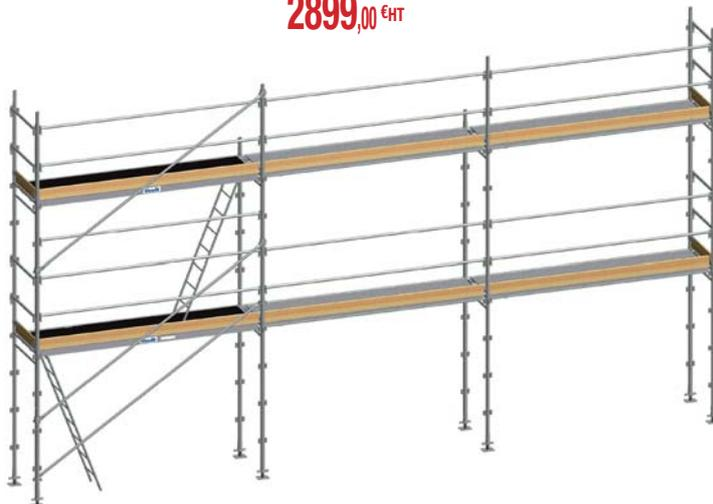
Echafaudage de façade - 60 m<sup>2</sup> - Longueur 9m - Hauteur de travail : 6m - Ø TUBES 50mm - Épaisseur 2mm - classe 4 (300 daN/m<sup>2</sup>) en travée de 3m - Entraxe des cadres 0,83m - Décret 2004-924 - Normes EN 12810 et EN 12811 - Acier galvanisé - Logo NF - Lisses et sous lisses - Plancher acier. Réf. FDA7
